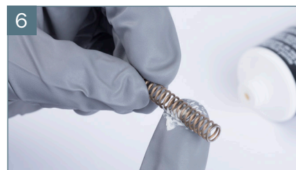
Farbnadelfeder einfetten und einsetzen
