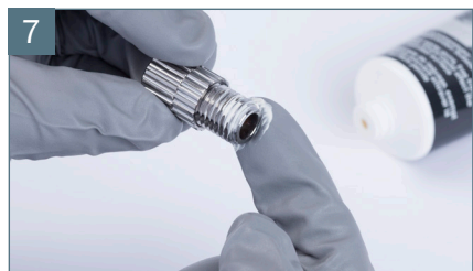
Gewinde der Materialmengenregulierschraube einfetten
