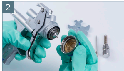
2 Dann erfolgt die Demontage der Luftdüse.
