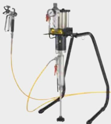
Die neue pneumatische Kolbenpumpe überzeugt durch ihre handliche und kompakte Bauweise. Der hohe Arbeitsdruck ermöglicht die leistungsstarke Verarbeitung von nieder- bis mittelviskosen wasser- und lösemittelhaltigen Materialien im Airless- als auch Aircoat Verfahren. Alle farbbrühenden Teile sind komplett in Edelstahl.
