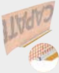
Selbstklebendes Kunststoffprofil für Anschlüsse von WDVS an Tür- und Fensterrahmen; gewährleistet (Anforderungsklasse III) in dreidimensionaler Richtung Schlagregensicherheit. Die TPE-Membran ist an der Vorderseite des Profils platziert. Eine Wasserführung im Inneren der Leiste wird somit verhindert. Zur Verhinderung von Rissen im Leistenstoßbereich ist das Profil in Längsrichtung mit 10 cm Gewebeüberstand ausgestattet.
