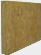
Dämmplatte aus versponnener Mineralwolle. Hergestellt durch Schmelzen von Gestein, Putzträgerplatte der Produktart MW-PT. (**Wärmeleitfähigkeit: 0,034 W/mK**).
