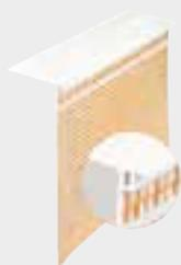
Kunststoffprofil mit 13,5 cm Gewebestreifen, Abzugsteg für 3 mm und 5 mm Unterputzschichtdicken und Tropfkante, zur exakten Anbindung der zweiten Dichtebene vorne unter den Fensterbänken.
