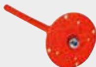
Der Schraubdübel wird während der Montage automatisch in den Dämmstoff eingezogen und anschließend durch PS-, Dalmatiner-, MF- oder Hanf-Rondellen verschlossen. Montage-Tool Rondelle zum Setzen des Dübels notwendig. Ist auch oberflächenbündig zu setzen, jedoch dann mit Capatect Dübelstopfen zu verschließen.
