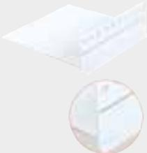
Kunststoff Grundprofil als Fassadenflächenabschluss bei zurückversetztem Sockel. Zur Verhinderung von Rissen im Stoßbereich und zur Einbindung in die Flächenarmierung wird nach der Sockel Thermo PLUS Montage das Capatect Aufsteckprofil Rolle Universal aufgeklipt. Die Ausladung vom Profil beträgt 10 cm, kann jedoch bei Bedarf aufgrund der vorhandenen Sollbruchstellen auf 8 cm bzw. 6 cm durch einfaches Abknicken gekürzt werden. 125 Stk. Kunststoffnägel im Gebinde beige packt.
