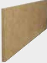
Dämmplatten aus versponnener Mineralwolle. Hergestellt durch Schmelzen von Gestein, Putzträgerplatte der Produktart MW-PT. (**Wärmeleitfähigkeit: 0,035 W/mK**)
