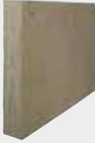
Fassadendämmplatte aus regionalen, nachwachsenden Rohstoffen gewährleistet eine höchstmögliche ökologische, stark diffusionsoffene Außenwanddämmung. Hervorragender Schallschutz und in Kombination mit Carbontechnologie stark erhöhter Hagelwiderstand. Dübellöcher im Dübelschema „W“ ab der Dicke  $\geq 6$  cm bereits werkseitig vorgefertigt. Rohdichte ca.  $92 \text{ kg/m}^3$ .
