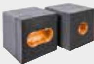
Ist ein rückseitig mit EPS-F (0,031) aufkaschierten 5 cm EPS-Hartschaum-Einbauteil mit schlagregensicher (Fugendichtband) und kraftschlüssig integriertem 1-fach bzw. 2-fach Elektro-Gerätedosen (Ø 60 mm) zur wärmebrückenfreien Befestigung von z.B. Steckdosen in WDVS.
