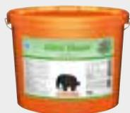
Wasserverdünnbare, reinigungsfähige, geruchsneutrale Einkomponenten-Silikatfarbe für innen. Geeignet auf allen mineralischen Untergründen sowie auf saugfähigen Dispersionsuntergründen. Nassabriebklasse 3, Deckkraftklasse 1 (Ergiebigkeit 5 m<sup>2</sup>/l bzw. 3,1 m<sup>2</sup>/kg), gemäß ÖNORM EN 13300.
