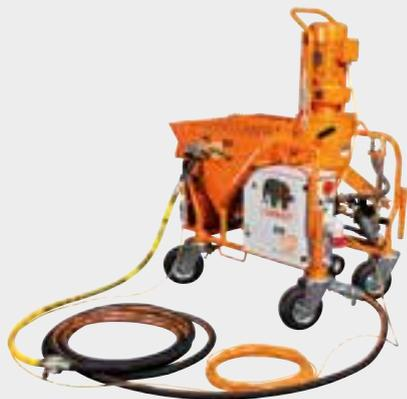
Die maximale Förderreichweite in der Basisvariante beträgt 25 m in der Höhe und max. 35 m im Radius. Mischt und pumpt kontinuierlich und vollautomatisch alle pulverförmigen Capatect Klebe- und Armierungsmörtel. Die Mischpumpe kann sowohl mit Sackware als auch mittels Trockenförderanlage direkt aus dem Silo pneumatisch gefüllt werden (ohne Starkstromkabel und Wasserschlauch). Sind höhere Reichweiten gefragt, ist dieses System auf Opus I+ erweiterbar.
