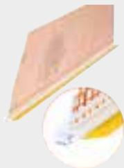
Selbstklebendes, schmales Kunststoffprofil der Anforderungsklasse III, für schlagregensichere Anschlüsse von WDVS an Fenster- und Tür-Rahmenkonstruktionen. Zur Verhinderung von Rissen im Leistenstoßbereich ist das Profil in Längsrichtung mit 10 cm Gewebeüberstand ausgestattet.
