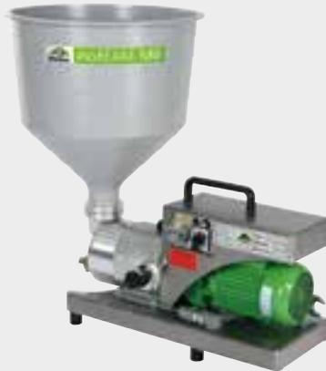
Die inoBEAM M8 ist eine handliche 230 V Peristaltik-Förderpumpe und beruht auf dem Walkprinzip. Dabei drückt eine flexible Gummisichelbe das Fördergut durch das Pumpengehäuse in den Materialschlauch. Wesentlicher Vorteil dabei ist, dass weniger Reibungswärme entsteht und das Material sehr schonend gefördert wird. Die sehr schnelle Reinigung und einfache Wartung halten die Betriebskosten niedrig und sparen Zeit.
