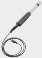
Zum Anschluss an das HPM touch pro Feuchtemessgerät. Messung nach dem Prinzip der kapazitiven Streufeldmessung. Für die zuverlässige und zerstörungsfreie Vorprüfung bei der Ermittlung der Belegreife von Estrichen, Beton und Putzen bis zu einer Tiefe von 5 cm. Erweiterung um die CM% Anzeige.
