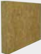
Dämmplatte aus versponnener Mineralwolle. Hergestellt durch Schmelzen von Gestein, Putzträgerplatte der Produktart MW-PT. (**Wärmeleitfähigkeit: 0,036 W/mK**).
