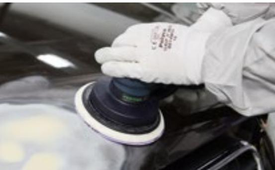
Die 3M™ Hookit™ 260L+ Purple Schleifscheiben sind optimal zum Beischleifen des Übergangsbereichs von Reparaturstelle und Altlack geeignet. Weitere Anwendungsmöglichkeiten sind das Entfernen von Staubeinschlüssen und Orangenhaut.
